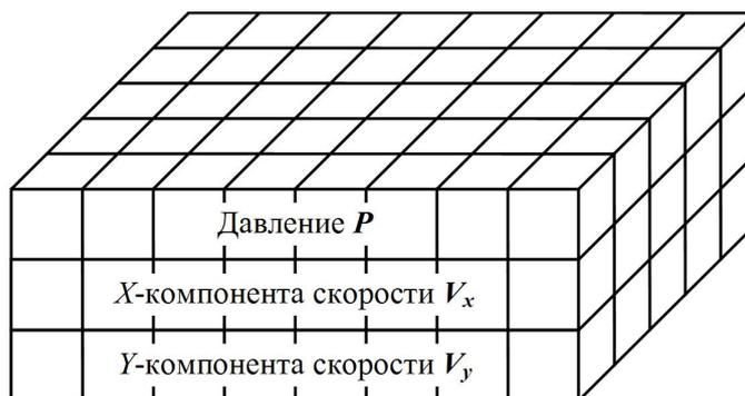
Рис. 2. Структура клеточно-автоматного поля двумерной модели потока
