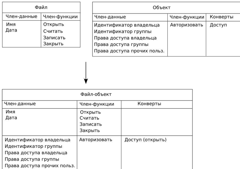
Рис. 6. Объединение класса и примеси на этапе трансляции
