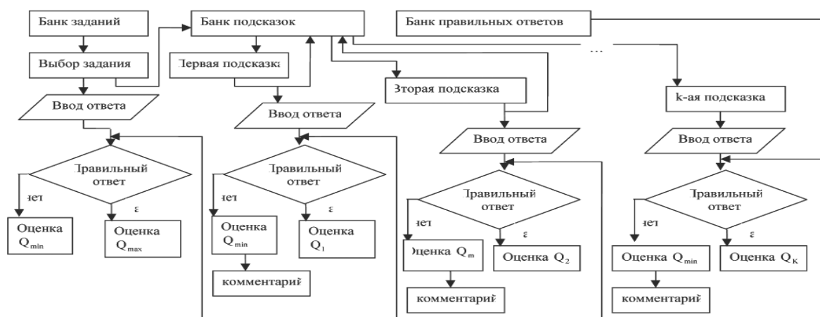
Рис. 2. Алгоритм адаптивного контрольно-обучающего тестирования (второй способ)
