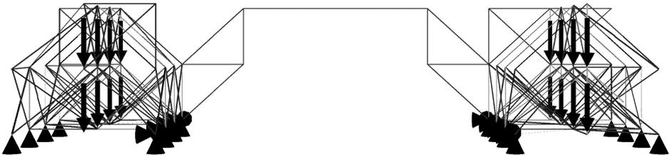
**Рис. 3.** Двести пятьдесят четвёртый шаг структурной оптимизации конструкции.
