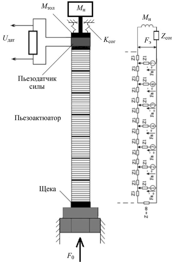
**Рис. 2.** Схема эксперимента по изучению влияния предварительного поджатия ПА при инерционной нагрузке:  $M_H$  – масса пригруза;  $K_{сог}$  – жесткость согласующего элемента конструкции;  $M_{тол}$  – масса толкателя;  $Z_{сог}$  – механический импеданс согласующих элементов;  $U_{дат}$  – сигнал с пьезодатчика силы;  $F_0$  – сила предварительного поджатия;  $F_3$  – эквивалентная сила
