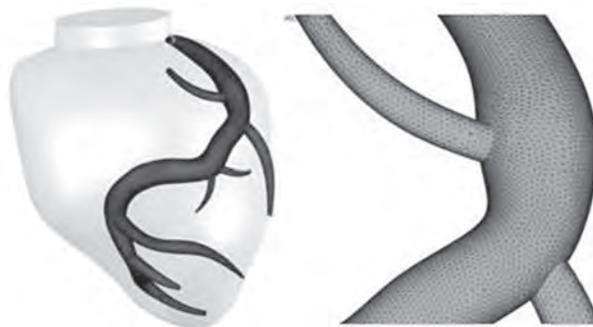
Рис. 5. Наложение расчетной сетки на модель ПВА
