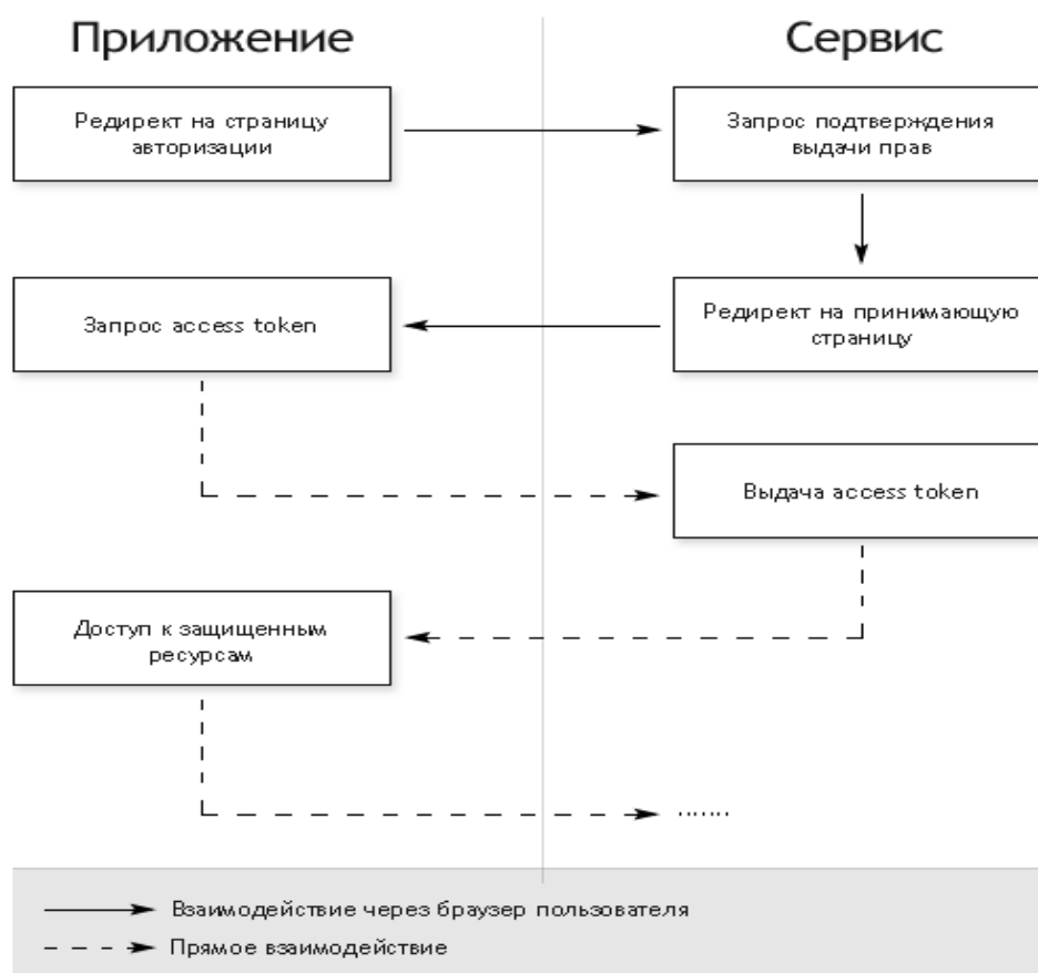
Рис. 1. Принцип взаимодействия приложений при авторизации с помощью протокола OAuth
