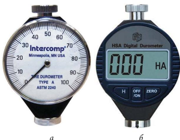
Рис. 12. Твердометры по Шору: а – обычный, б – цифровой
