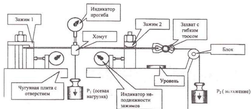
Рис. 1.Схема нагружения спиц и измерения прогиба при осевых нагрузках.
