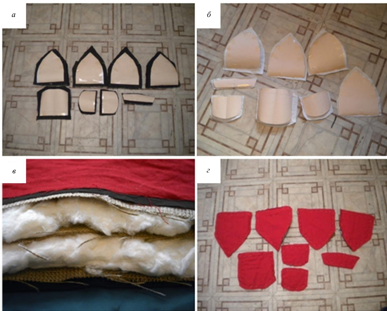
Рис. 2. Раскрой и наполнение шапки бумажной: а) раскрой основного элемента шапки бумажной; б) раскрой подклада шапки бумажной; в) наполнение шапки бумажной; г) сбор всех слоев в части основного элемента шапки бумажной
