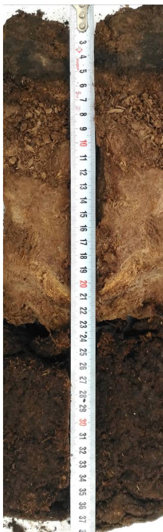
Рис. 2. Керн торфяных отложений долины р. Ингода
