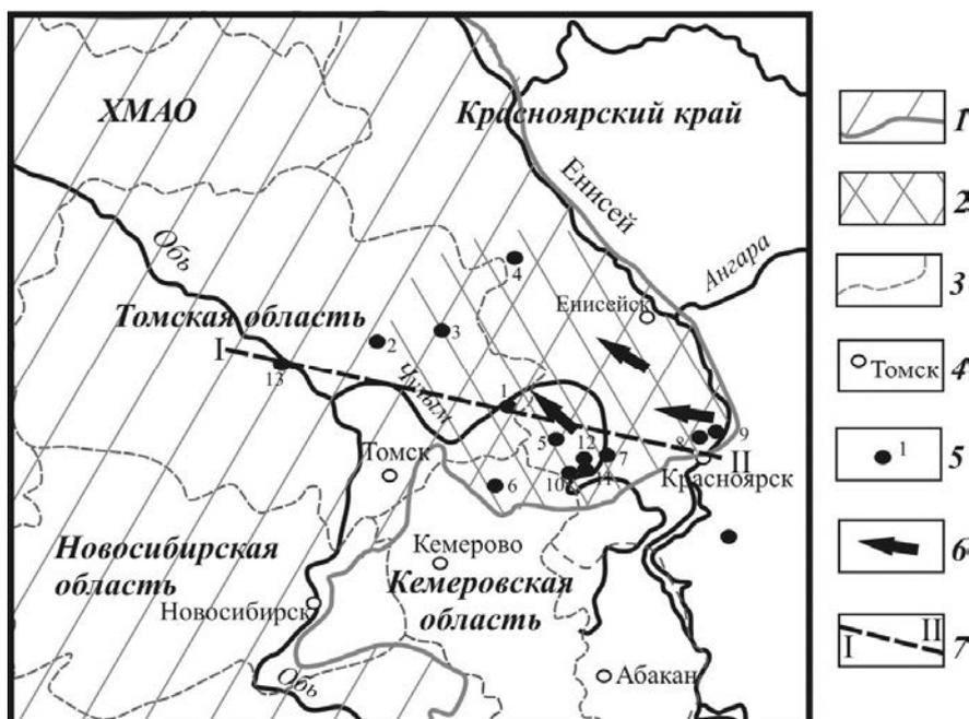
Рис. 1. Схема расположения объекта исследования: 1 – граница и область распространения Западно-Сибирского артезианского бассейна; 2 – область распространения Чулымо-Енисейского гидрогеологического района; 3 – границы административных областей; 4 – населенные пункты; 5 – скважины и их номер; 6 – направление движения подземных вод; 7 – линия гидрогеохимического разреза
