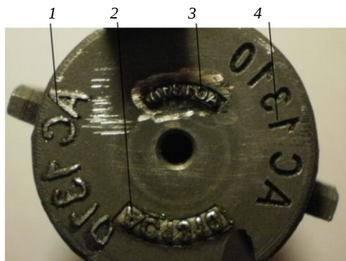
Рис. 5. Чашка затвора гладкоствольного карабина «Вепрь» 12-го калибра с нанесенными баллистическими маркерами: 1 – наплавка металла с использованием импульсной лазерной сварки; 2 – литерный способ с высоким шрифтом; 3 – литерный способ микротекста в прикапсюльной зоне; 4 – выборка металла гравером
