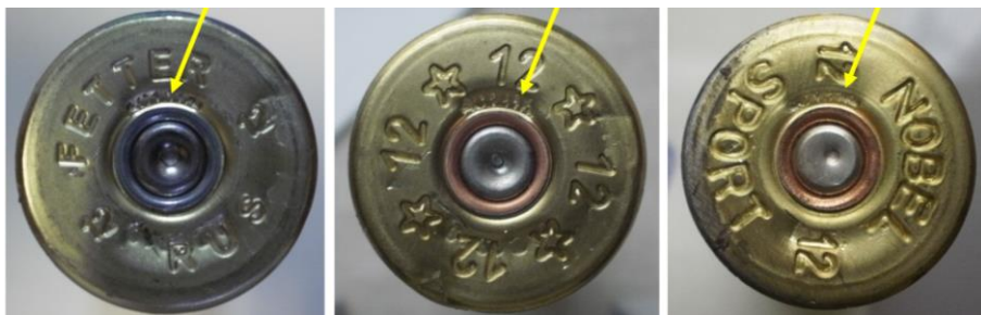
Рис. 7. След баллистического маркера на валике в прикапсюльной зоне шляпки гильзы
