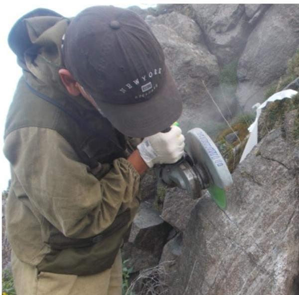
Рис. 3. Отбор штуфной бороздовой пробы К-1 из коренного обнажения полосчатого оливинового габбронорита с применением алмазной пилы «болгарки»
