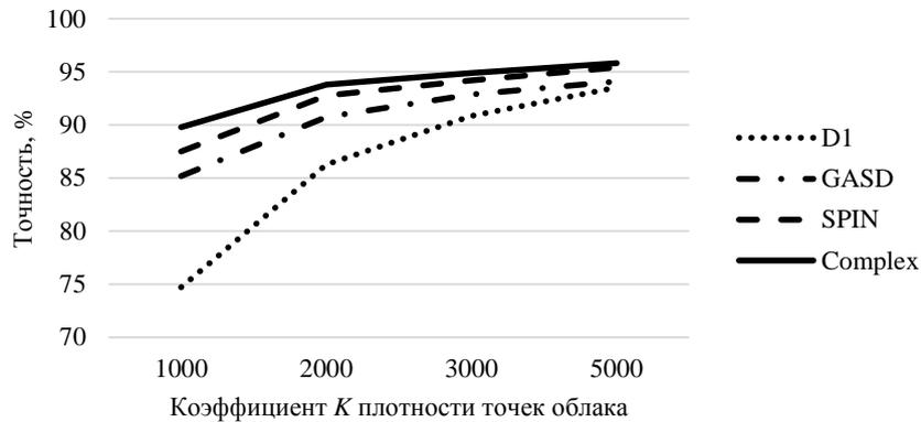
Рис. 1. Точность распознавания при различной плотности облаков точек
