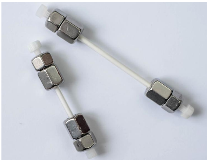
Рис. 1. Внешний вид монолитной колонки.
