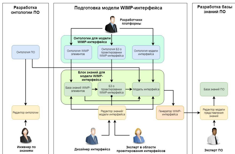
Рис. 2. Формирование редактора с адаптивным WIMP-интерфейсом
