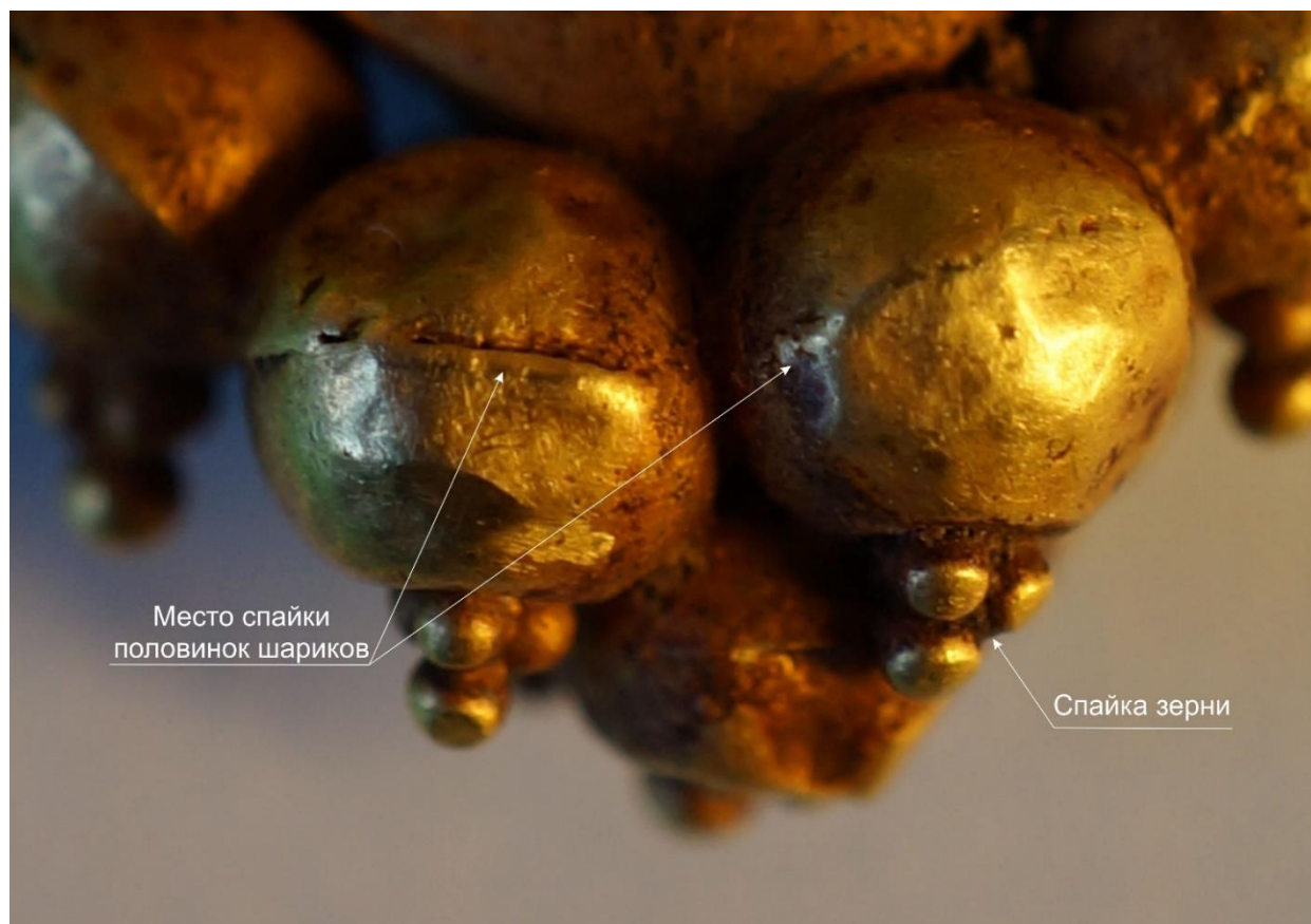
Рис. 7. Место спайки половинок шариков подвески
