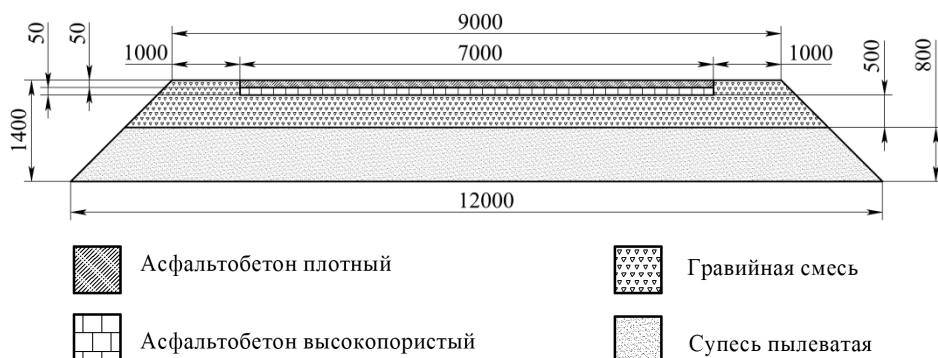
Рис. 1. Схема дорожной одежды, размеры даны в мм
