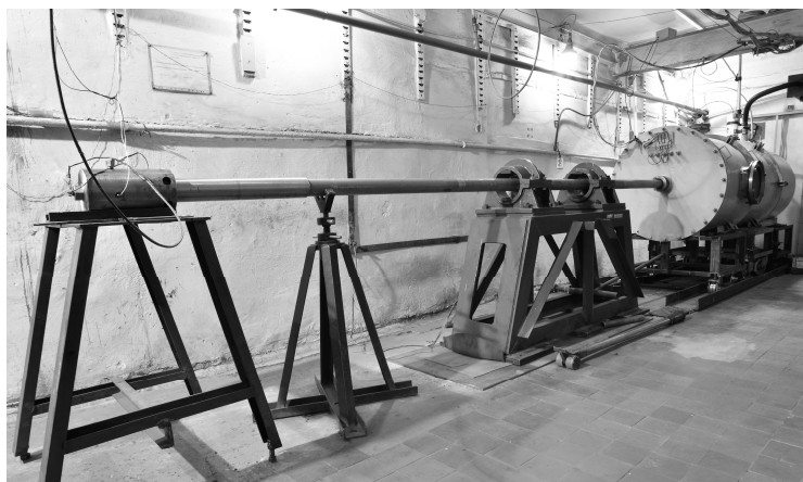
Рис. 1. Внешний вид модельной баллистической установки и вакуумируемой баллистической трассы
