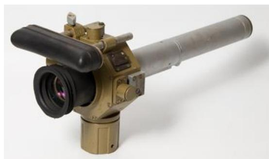
Рис. 3. Прицел оптический прямой наводки ОП-1 [7]
