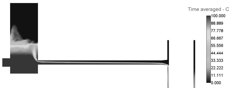
Рис. 5. «Слепой» тест, средняя концентрация тяжелой жидкости (интервал осреднения 10–15 с)
