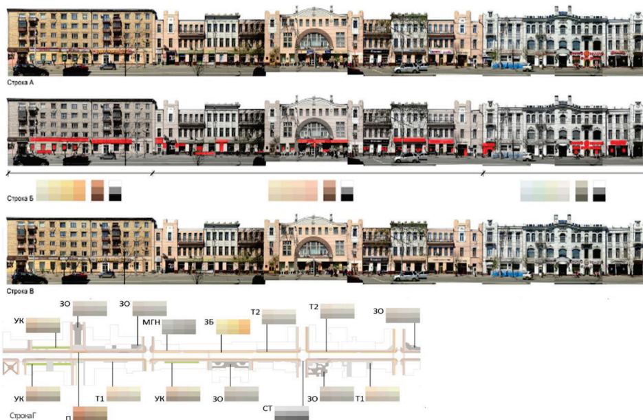
Рис. 9. Методика построения средовой колористики проспекта Мира: строка А – существующая развертка улицы; строка Б – колористическое решение рекламных вывесок, выбивающихся из общей стилистики здания; строка В – предложение по дизайну рекламных вывесок; строка Г – схема предельно допустимой цветовой градации для мощения на рассматриваемом фрагменте Fig. 9. Methods for constructing the environmental colorist of Prospect Mira: line A – existing street sweep; line Б – the coloristic solution of advertising signs that stand out from the general style of the building; line В – a proposal for the design of advertising signs; line Г – a diagram of the maximum permissible color gradation for paving on the fragment under consideration
