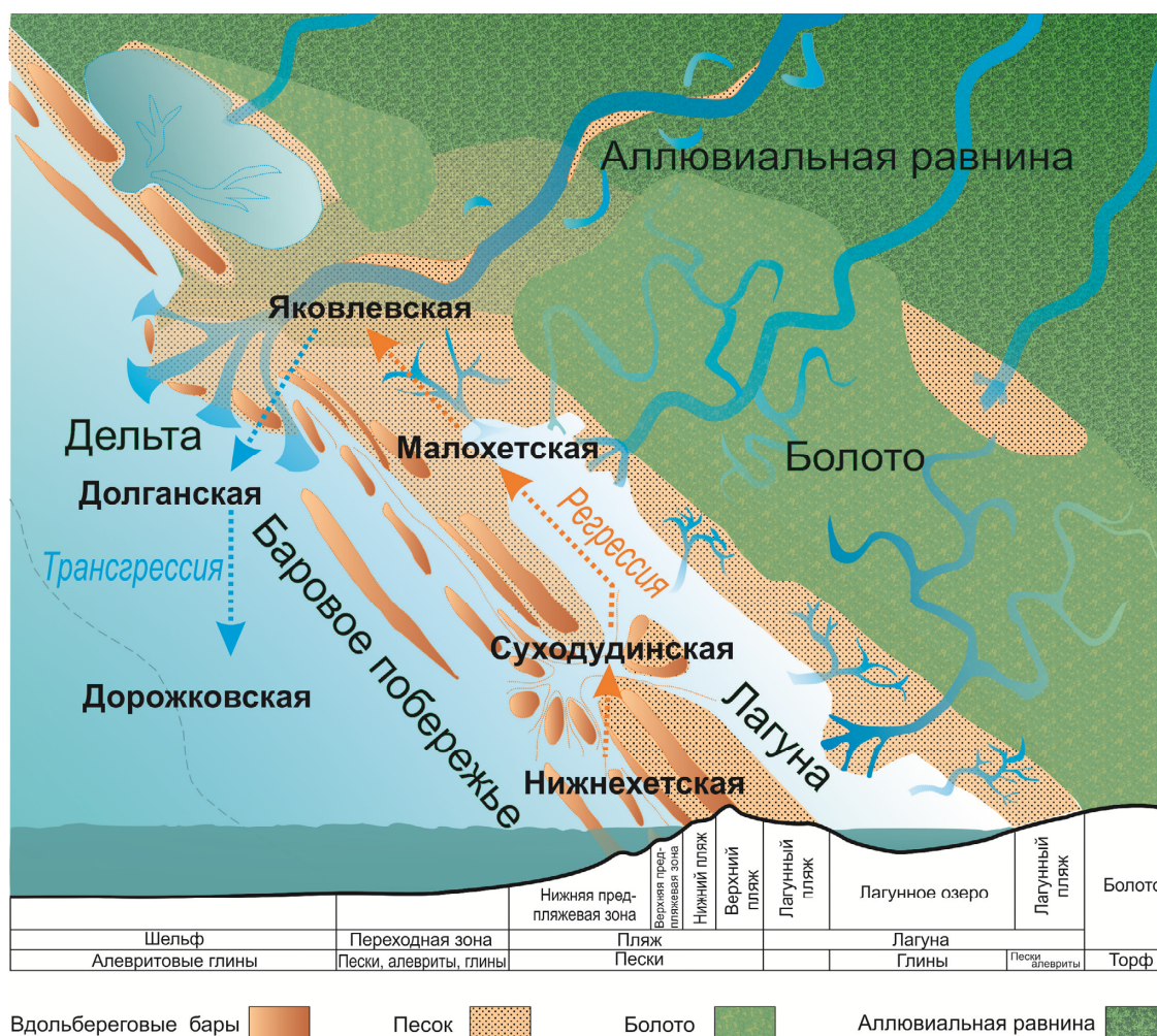
Рис. 8. Схема фациальных обстановок осадконакопления отложений меловых продуктивных песчаных пластов на территории Лодочного нефтегазоконденсатного месторождения
