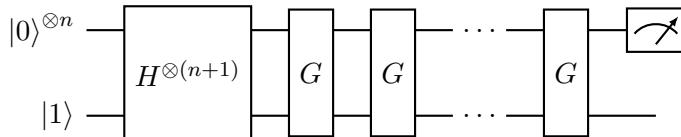
Рис. 1. Алгоритм Гровера [3]:  $H$  — вентиль Адамара;  $G$  — итерации Гровера (рис. 2)
