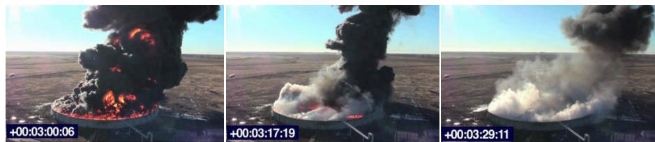
Рис. 8. Эффективное тушение пожара новым методом в полностью заполненном топливном резервуаре объемом 20\,000 \text{ м}^3
