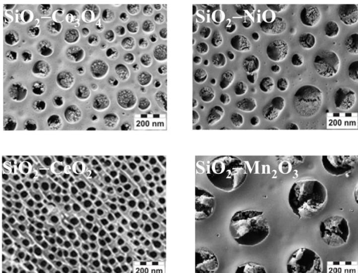
Рис. 2. Микрофотографии пленок с концентрацией  $\text{M}_x\text{O}_y$  20–30 мас. %
