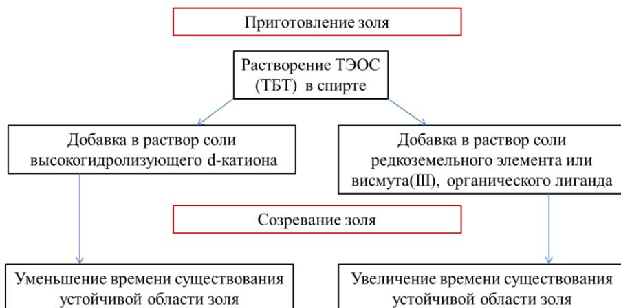
Рис. 1. Схема приготовления золя с разными временными интервалами устойчивой области пленкообразования
