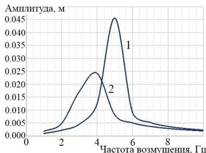
**Рис. 6.** Амплитудно-частотная характеристика средней точки вала: 1 – для не вращающегося; 2 – для вращающегося вала
