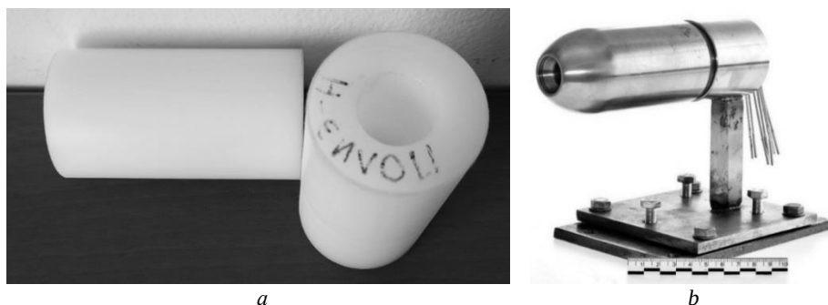
Рис. 3. Для физического моделирования: a – наполнитель из легкоплавкого материала, b – модельное тело для экспериментов
