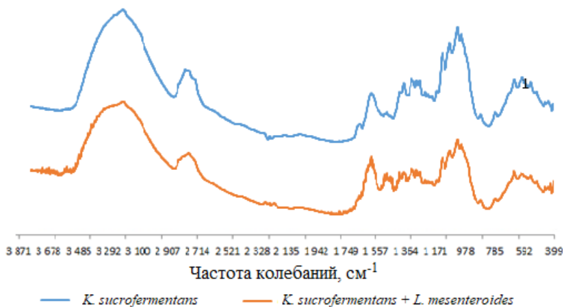
Рис. 8. ИК-спектры бактериальной целлюлозы, полученной при монокультивировании Komagataeibacter sucrofermentans B-11267 и совместном культивировании Komagataeibacter sucrofermentans B-11267 и Leuconostoc mesenteroides BKM B-2317D
