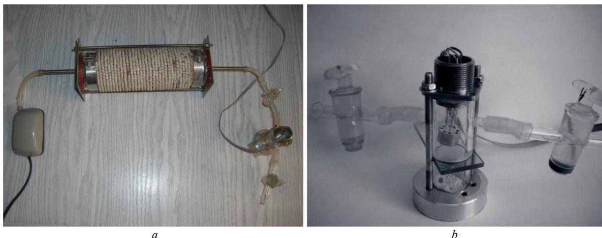
**Рис. 3.** Устройство для прокачки воздуха, очищенного с помощью цеолитового фильтра через измерительную камеру (a) и измерительная камера (b)
