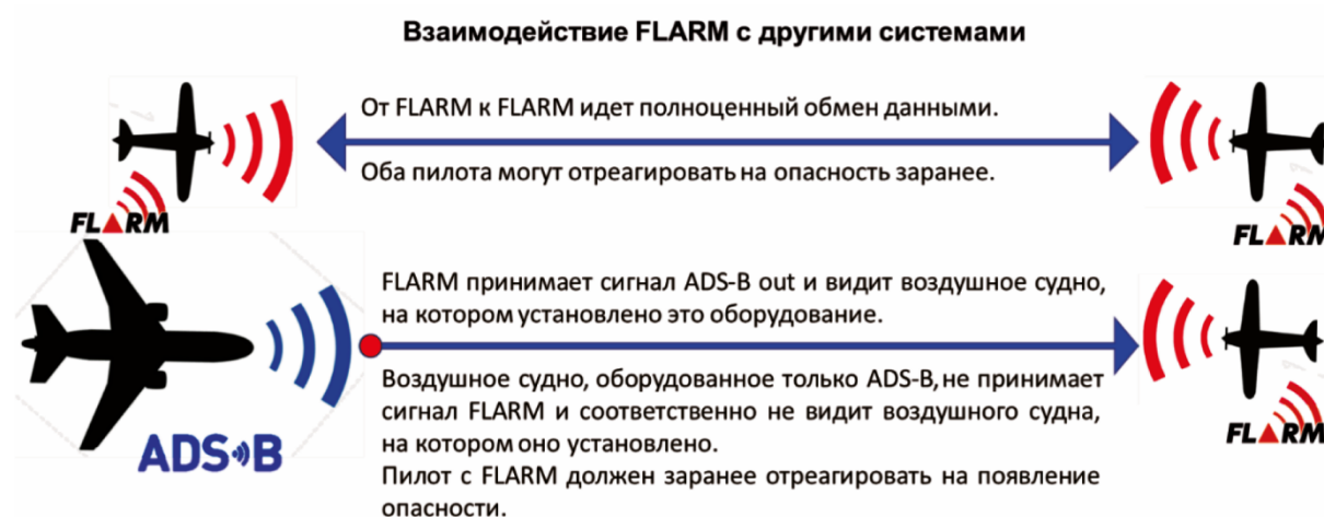
Рис. 5. Алгоритм работы FLARM
