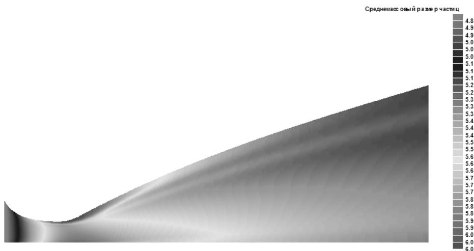
Рис. 16. Распределение среднемассового диаметра частиц
