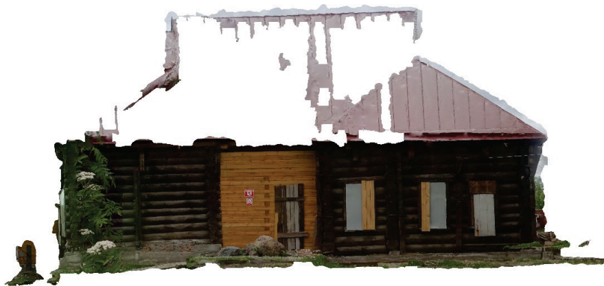
Рис. 4. Дом и контора управляющего Сузунским медеплавильным заводом в р.п. Сузун. Облако точек, снятое в неблагоприятных условиях. Белые пятна – «дыры» или «тени»
