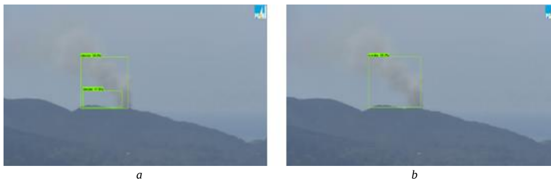
Рис. 4. Визуализация результата работы алгоритма постобработки: а – результат отображения прогнозов на результирующем кадре; б – результат работы алгоритма кластеризации прогнозов
