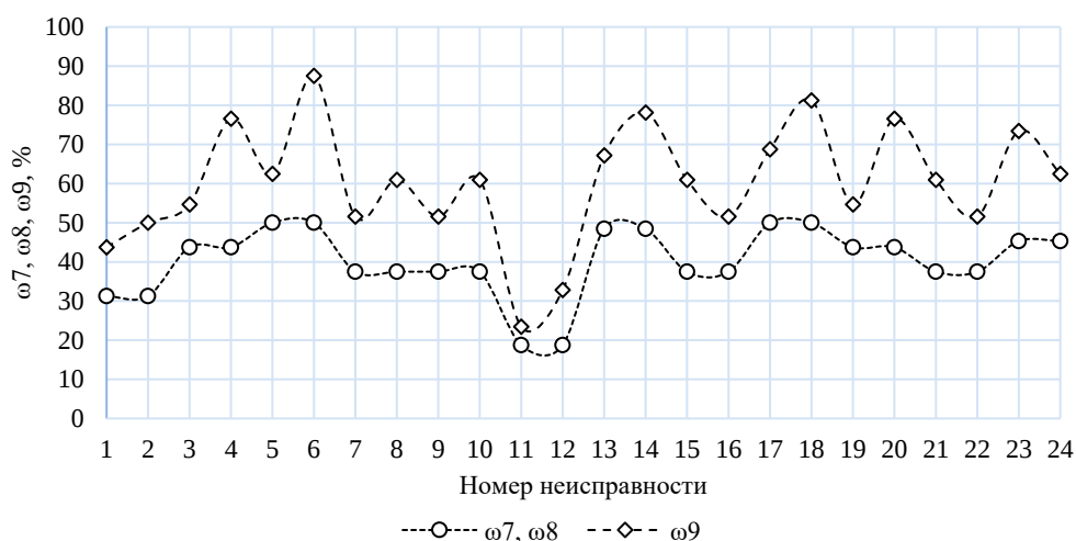
Рис. 7. Графическое изображение показателей \omega_7, \omega_8, \omega_9 для различных неисправностей тестовой схемы Fig. 7. Graphical representation of indicators \omega_7, \omega_8, \omega_9 for various test circuit faults
