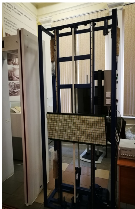
Рис. 4. Вид прототипа радиоволновой бесконтактной системы досмотра
