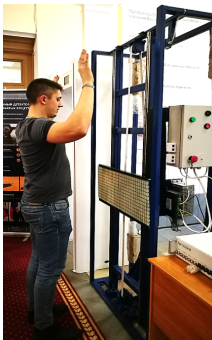
Рис. 4. Вид прототипа радиоволновой бесконтактной системы досмотра
