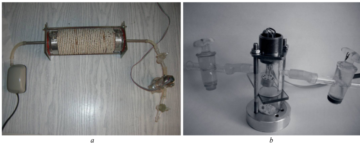
Рис. 3. Устройство для прокачки воздуха, очищенного с помощью цеолитового фильтра через измерительную камеру (a) и измерительная камера (b)
