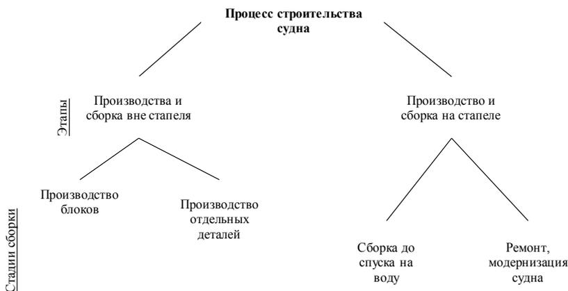
Рис. 2. Этапы и стадии процесса строительства судна
