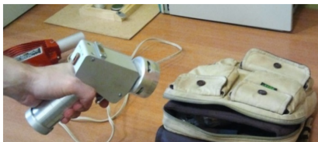
Рис. 8. Применение вихревого пробоотборного устройства для обследования объекта
