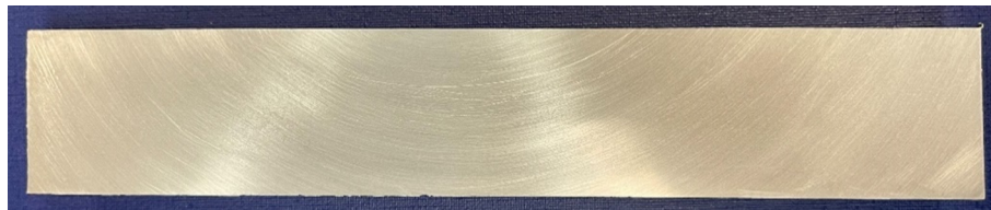
Рис. 3. Продольное сечение отливки АК12, полученной при вибрационной обработке во время заливки с частотой 60 Гц и виброперемещением 99 \pm 4 мкм
