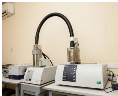
Рис. 3. Прибор синхронного термического анализа (дериватограф) STA 409 PC LUXX® + квадрупольный масс-спектрометр QMS 403 AEOLOS»
