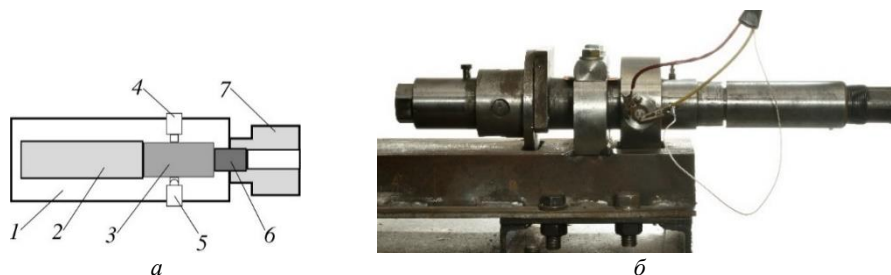
Рис. 3. Схема сопловой установки (а) и ее внешний вид (б): 1 – корпус, 2 – место расположения исследуемого топлива в камере сгорания, 3 – место расположения порохового заряда, 4 – датчик давления, 5 – воспламенительное устройство, 6 – сопло со снарядом-заглушкой, 7 – сопловой блок
