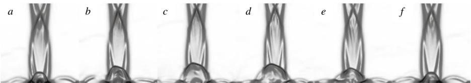
**Рис. 6.** Эволюция ударно-волновой структуры течения в окрестности преграды для расчетной конфигурации с движением преграды против течения струи в моменты времени: *a* – 0.0226 с, *b* – 0.0227 с, *c* – 0.0228 с, *d* – 0.0229 с, *e* – 0.023 с, *f* – 0.0231 с
