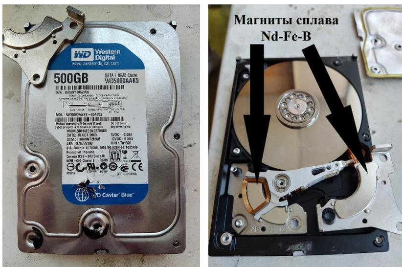
Рис. 1. Разобранный вручную жесткий диск фирмы Western Digital
