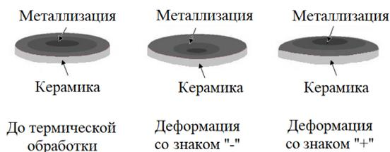
Рис. 4. Схематическое изображение процесса деформации металлизированного диска после высокотемпературной обработки
