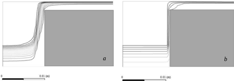
Рис. 3. Траектории частиц, исходящих от инициатора в момент времени 8 мс: r = 1 мкм ( a ), r = 25 мкм ( b )
