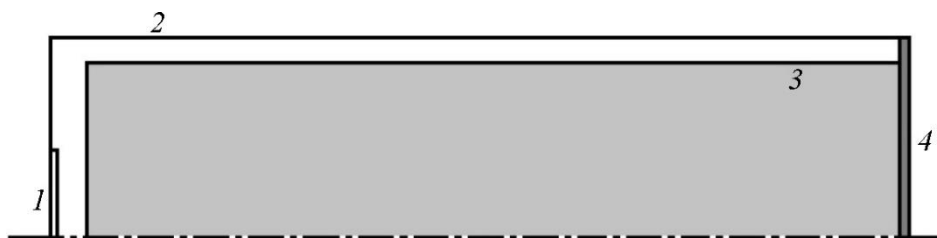
Рис. 1. Внешний вид изделия: 1 – инициирующее устройство, 2 – корпус, 3 – таблетка-излучатель, 4 – мембрана
