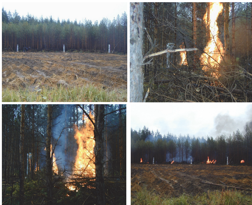
Рис. 8. Тушение низового лесного пожара при групповом воздействии АСП-500
