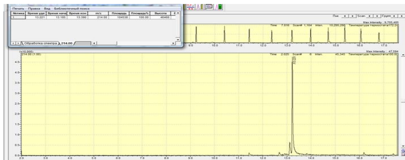
Рис. 5. Хроматограммы по полному ионному току: a – исходного раствора DCF; б – в условиях гетерогенного фотокатализа; в – в условиях совмещенного гетерогенного фотокатализа и процесса «Пероксон»
