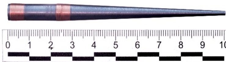
Рис. 1. Внешний вид калиберного суперкавитирующего ударника
