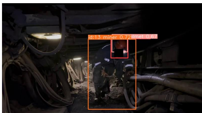
Рис. 3. Пример выделения объектов при тестировании моделей СНН с применением библиотеки OpenCV python Fig. 3. Example of object selection when testing SNN models using the OpenCV python library
