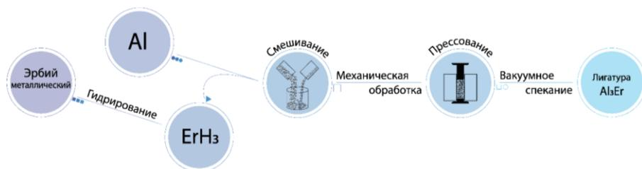
Рис. 1. Схема получения лигатуры  $Al_3Er$
