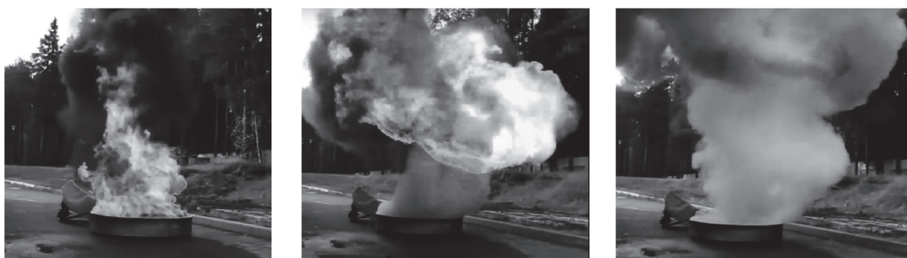
Рис. 1. Процесс тушения модельного очага возгорания бензина (площадь – 1,75 м 2 ) исследуемым огнетушащим порошковым составом (масса заряда огнетушителя – 4 кг)
