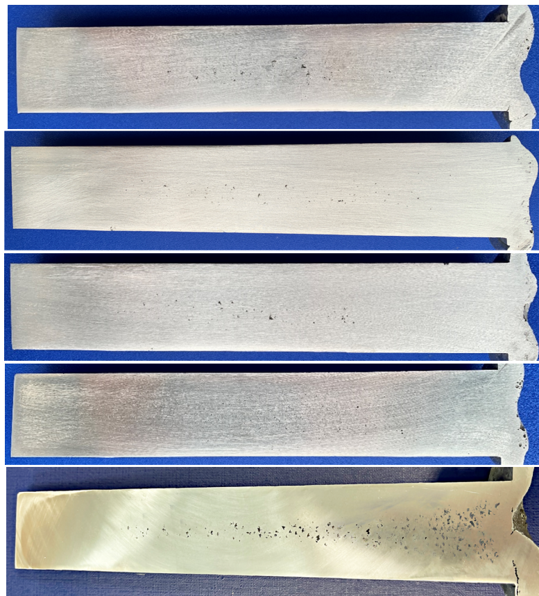
Рис. 2. Продольное сечение отливок АК12, полученных при вибрационной обработке с частотой и виброперемещением соответственно 0 Гц и 0 мкм ( a ); 50 Гц и 103 \pm 12 мкм ( b ); 50 Гц и 172 \pm 27 мкм с резонансом ( c ); 100 Гц и 144 \pm 22 мкм ( d ); 75 Гц и 99 \pm 27 мкм до полной кристаллизации ( e )
